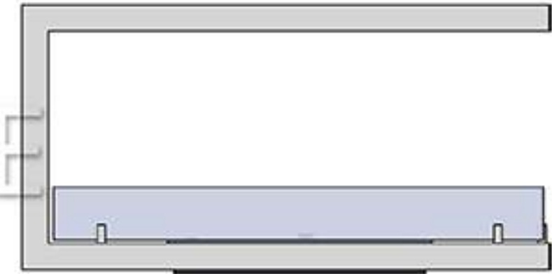
Расположение стекла на вертикальных креплениях внутри очага
