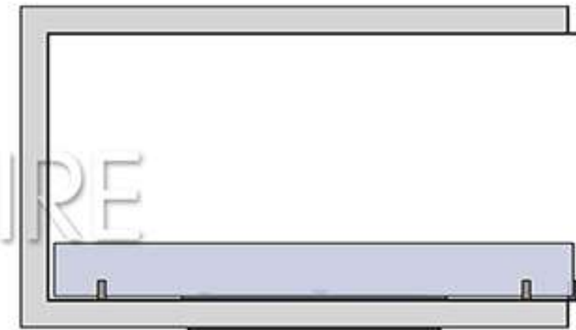
Расположение стекла на вертикальных креплениях внутри очага
